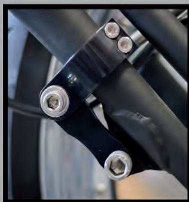
SUPPORT DE PATTE D'ETRIER DE FREIN POUR MONTER UN DISQUE DE 11,5" SUR FOURCHE SPRINGER DE REPRODUCTION
